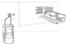
LOKALISEREN VAN EEN STROOM-ONDERBREKER IN EEN KAST
