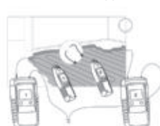
LOKALISEREN VAN EEN BREUK OP EEN VERWARMINGSKABEL
