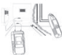
LOKALISEREN VAN WATERLEIDINGEN IN MUREN
