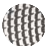
BATARD avec brise-copeaux
