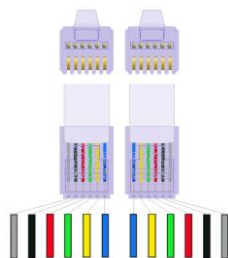
Figuur 5 Fiches gekruiste RJ12-kabel
